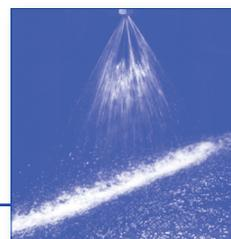
Стандартное исполнение с конической самоуплотняющейся резьбой. Стабильный угол факела распыла.
