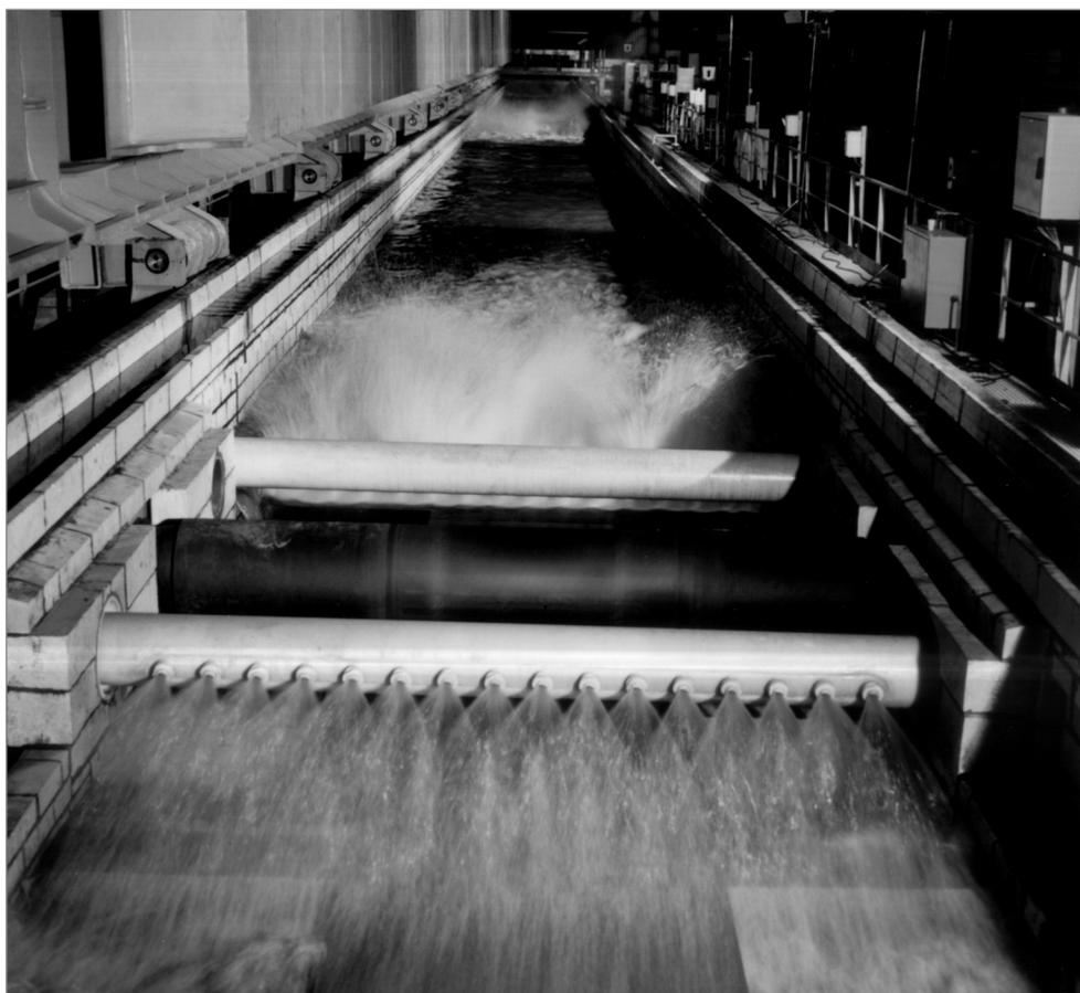
Устройство для предварительной обработки на линии протравливания
